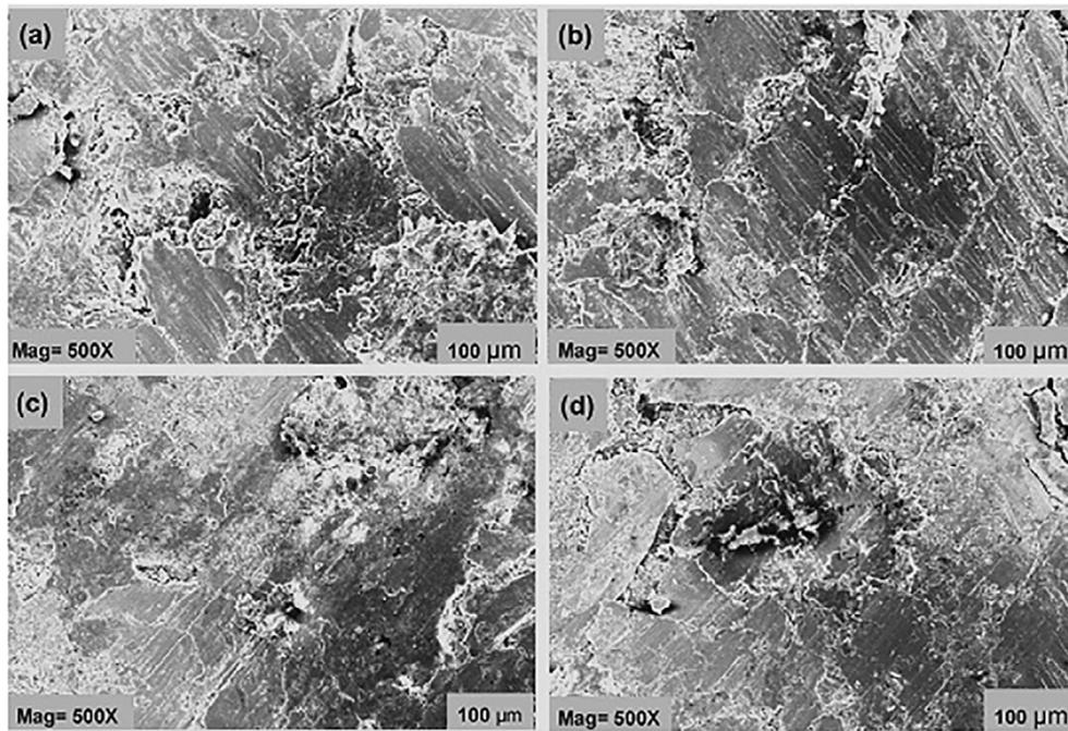
Fig. 8. SEM micrographs showing the worn surfaces of (a)  $C_0$  (b)  $C_1$  (c)  $C_2$  (d)  $C_3$ .
