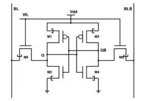
FIGURE 7. 6T TFET SRAM cell.
